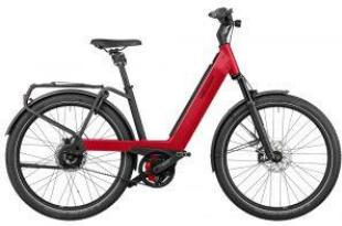
Le Reise & Muller est un speed bike au design classique, doté d'une propulsion puissante et fiable (jusqu'à 45 km/h). Moteur puissant sur le pédalier. Autonomie entre 90 et 120 km. Écran avec connectivité Bluetooth. Accessible avec permis AM ou BSR dès 14 ans.
