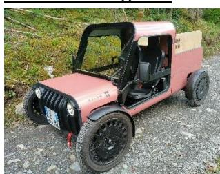
Homologuée dans la catégorie des quadricycles lourds, la Bagnole est un mini-pick-up biplace électrique roulant à 80 km/h et doté de 100 kilomètres d'autonomie, accessible avec permis B. Il permet d'emporter 600l de volume dans la benne pour une charge 150kg. Il se recharge sur une prise domestique.
