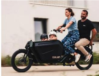
Le Formidable est un vélo cargo rallongé capable d'emmener 2 adultes et 2 enfants ou 120 kg de charge utile dans la caisse et sur le porte bagage renforcé. Avec son moteur Valéo et sa boîte de vitesses intégré il est capable de s'adapter automatiquement aux conditions de route et apporte une assistance jusqu'à 25km/h. Accessible à tous, il nécessite néanmoins un période d'adaptation compte tenu de son gabarit.
