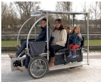
Le Vhélio intégral est un trike solaire à assistance électrique capable d'emmener 2 adultes et 2 enfants ou 240 kg de charge utile. La position assise est très confortable, seul le pilote pédale et le moteur apporte une assistance jusqu'à 25km/h. Accessible à tous, il nécessite une petite période d'adaptation.
